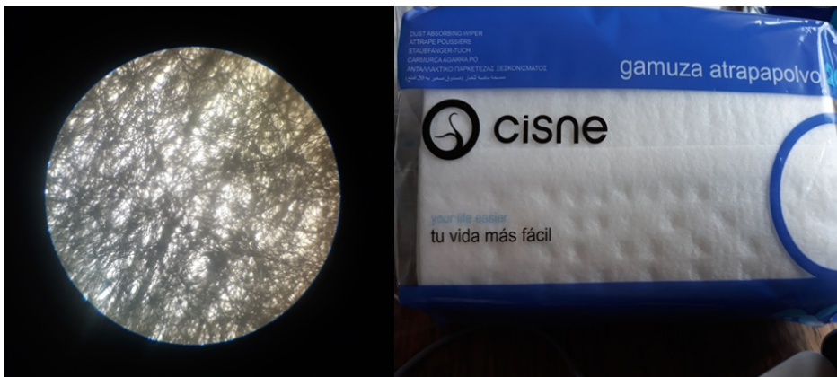
Bild 2: Einwegreinigungstuch #1 in 40-facher Vergrößerung
